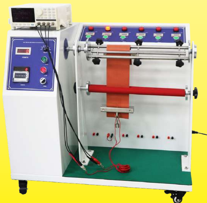
Calentador de silicona flexible durante la prueba de flexión
