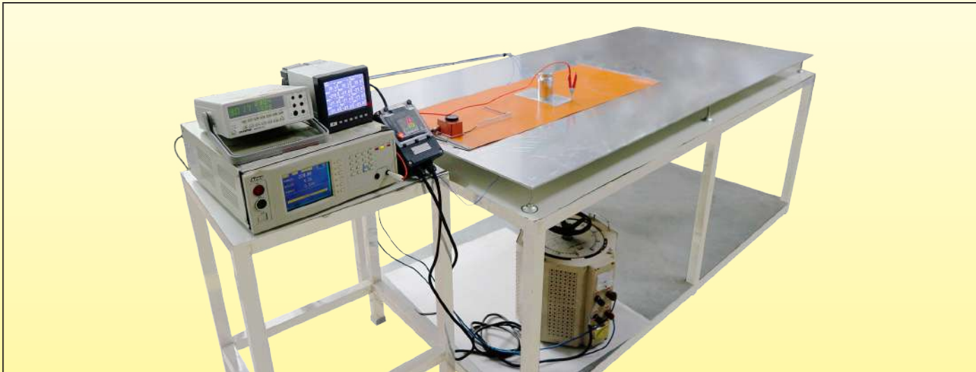
Equipo de medición para la corriente total de fuga en caliente
